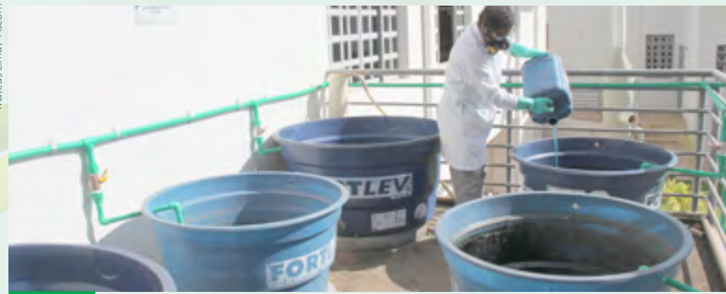
Nestes tanques, ocorre a degradação de matérias orgânicas em gás carbônico e água, não prejudiciais ao meio ambiente
