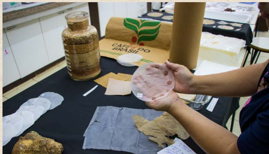
MAIS IMPERMEÁVEIS, OS FILMES PRODUZIDOS COM NANOFIBRAS CELULÓSICAS PODERÃO SERVIR PARA REVESTIR EMBALAGEM DE CAFÉS ESPECIAIS
